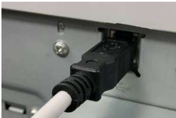
ต่อสาย USB ที่หลังเครื่องพิมพ์
